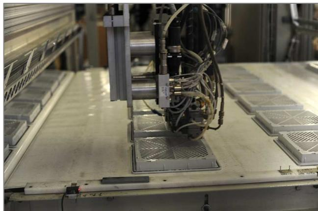
Уплотнительная прокладка в продукции Провенто выполнена в виде литой прокладки из полиуретана, наносимой роботом непрерывной отливки (точно так же, как у Rittal и Pfannenbergl).
